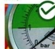
Escala / resolución de 0,2 bar para presiones de trabajo \leq 5 bar.
