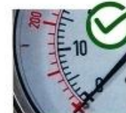
Escala / resolución de 1 bar para presiones de trabajo de 5 bar a 20 bar.
